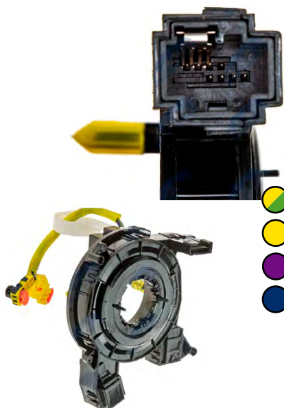
Tipo: Sensor de Ângulo de Direções Referência Original: DG9T14A664ABW Pinos: 8+14+10 Aplicações: FORD Mondeo Mk5 Carrinha (CF), Mondeo Mk5 Hatchback (CE), Mondeo Mk5 Sedan (CD)
