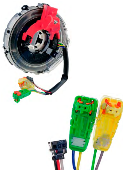
Tipo: Sensor de Ângulo de Direções Referência Original: A1714640118 Aplicações: MERCEDES-BENZ CLS Coupe (C219), Classe ML (W164), Classe R (W251, V251), GL (X164)
